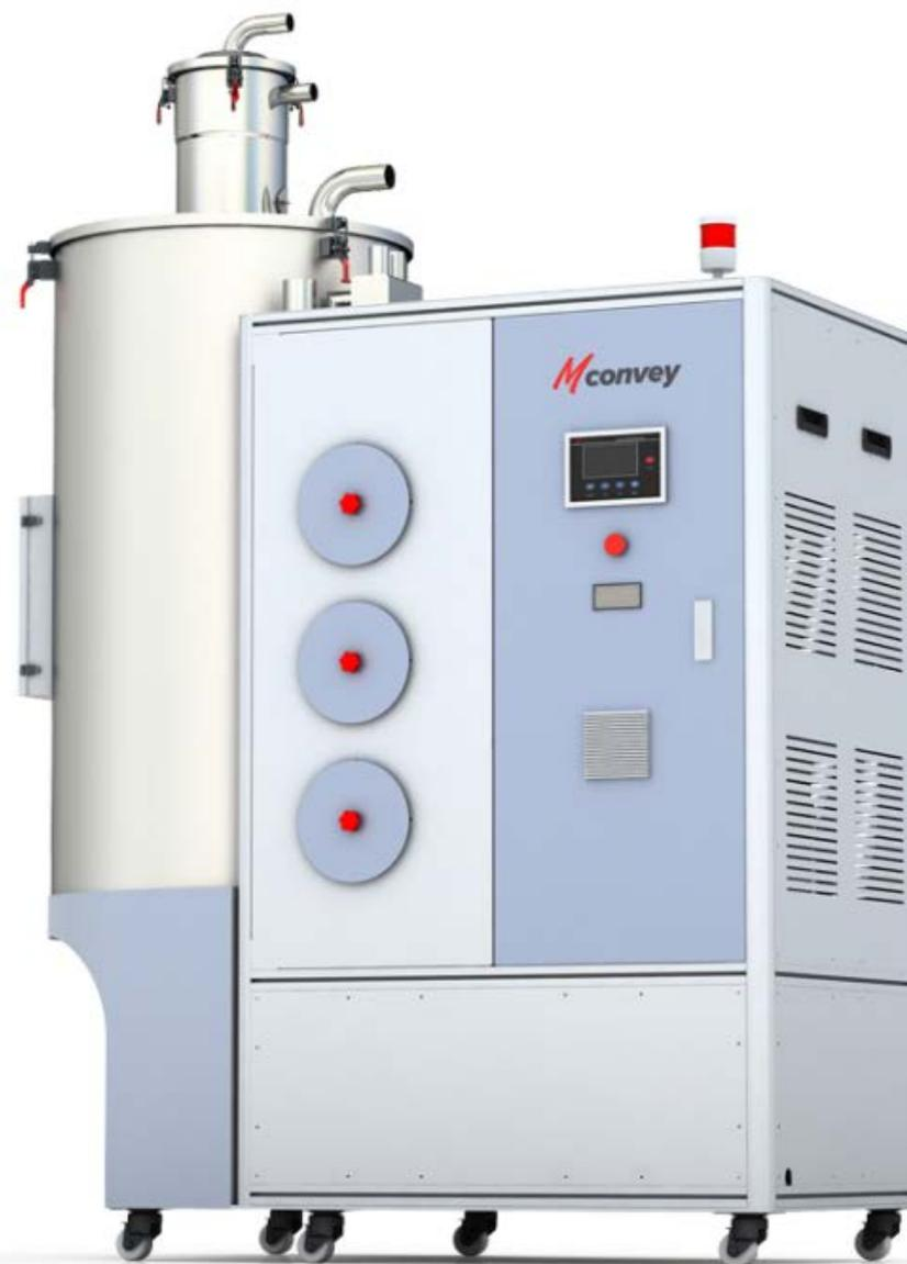
Горячий и влажный воздух, возвращающийся из сушильного бункера, охлаждается и поступает в сотовый ротор. При этом влага из воздуха поглощается ротором. По мере вращения ротора влага в воздухе непрерывно поглощается и десорбируется для сброса, и, наконец, образуется воздух со стабильно низкой точкой росы, который нагревается до температуры сушки, требуемой пластиковым материалом, а затем выдувается в сушильный бункер, образуя замкнутый контур циркуляции.
